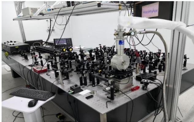
图 1：高压泵浦-探测超快光谱系统实物图
